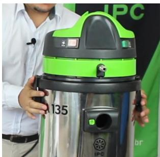
Ao posicionar o cabeçote, alinhe o engate rápido do cabeçote com o bocal de aspiração do tanque de aço.
