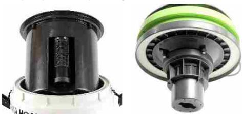
É no balde que está a boia de segurança. À medida que o tanque enche a boia sobe e, em um determinado nível ela bloqueia a aspiração, para evitar que a água chegue até o motor. No caso dos aspiradores e das extratoras com balde de água limpo externo, como a Lavaclean e a EA262, a boia de segurança fica encaixada direto no cabeçote. Se durante o uso você perceber que a aspiração
